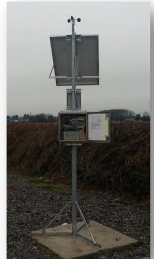
Stazione di allarme vento e polveri MicroMET-Alarm
